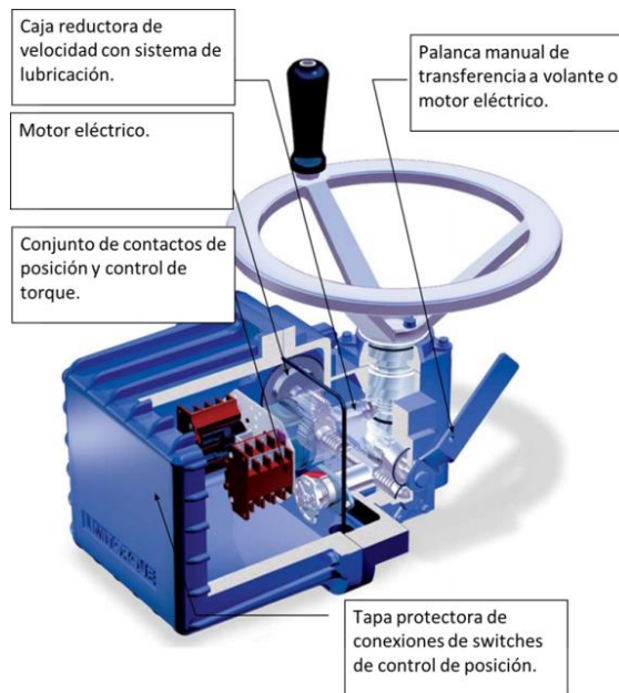
Figura 33. Actuador eléctrico de corriente alterna, con controles de posición y torque para válvula
