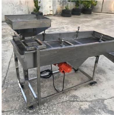
Fuente: Alibaba (2022). *Size grading machine poder vibrating screener coffee bean sieve.* Consultado el 10 de mayo de 2022. Recuperado de <https://spanish.alibaba.com/product-detail/size-grading-machine-powder-vibrating-screener-1700001117158.html>.
