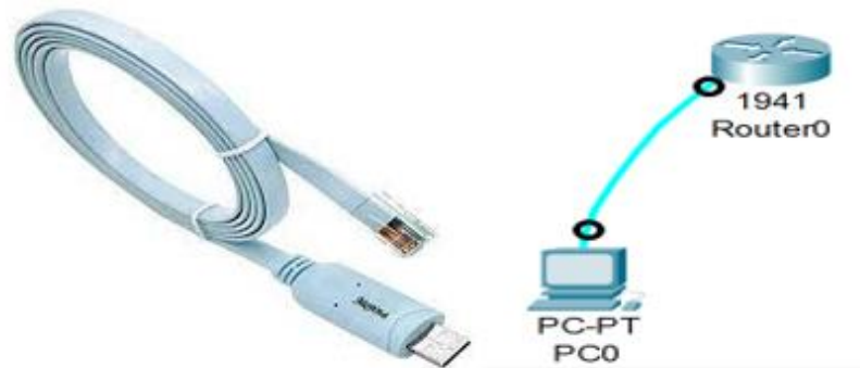
Figura 57. Conexión por cable de consola
