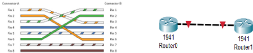
Figura 55. Configuración y conexión de cable cruzado
