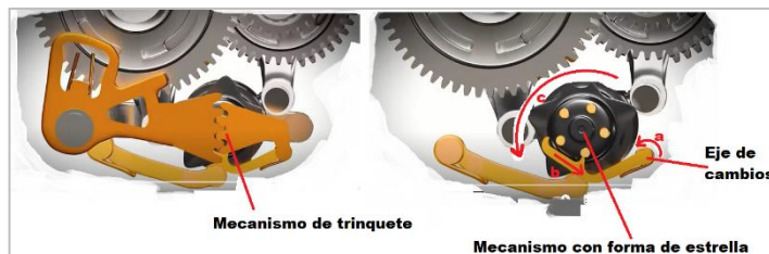
Figura 47. Funcionamiento del variador de ángulo en un tambor selector de cambios
