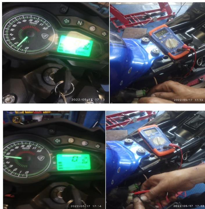
Figura 12. Mediciones de voltaje AC en embobinados de un rotor de motocicleta 150z mientras varían las rpm
