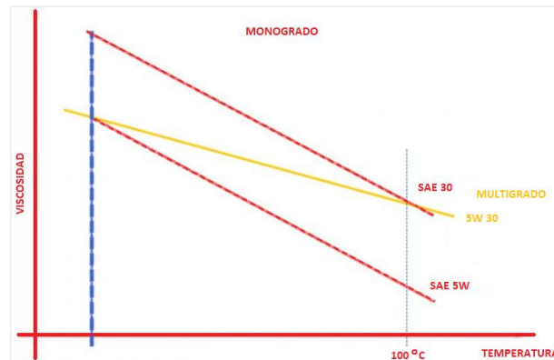
Figura 7. Comportamiento aceite de base mono grado comparado con el de aceite de base multigrado con respecto la temperatura de operación
