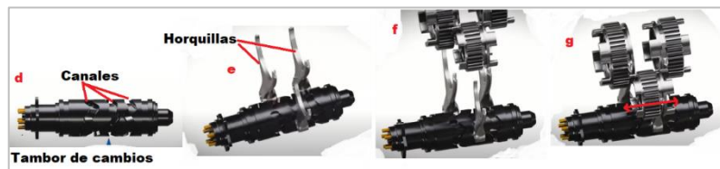
Figura 48. Funcionamiento de la caja de cambios en una motocicleta
