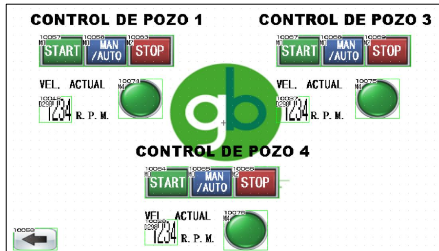
Figura 28. Panel de control de pozos
