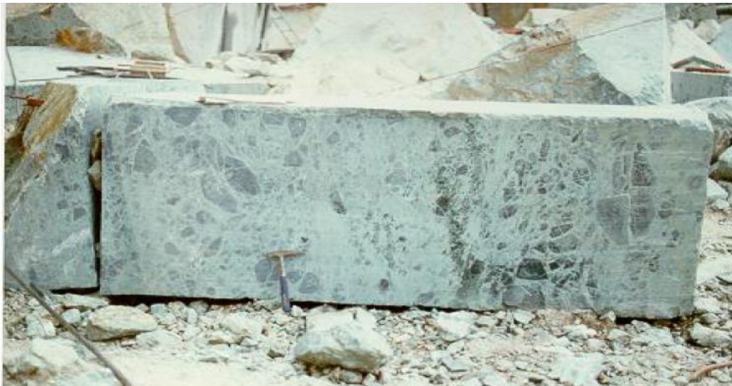
Figura 4. Corte longitudinal de una pieza de serpentinita
