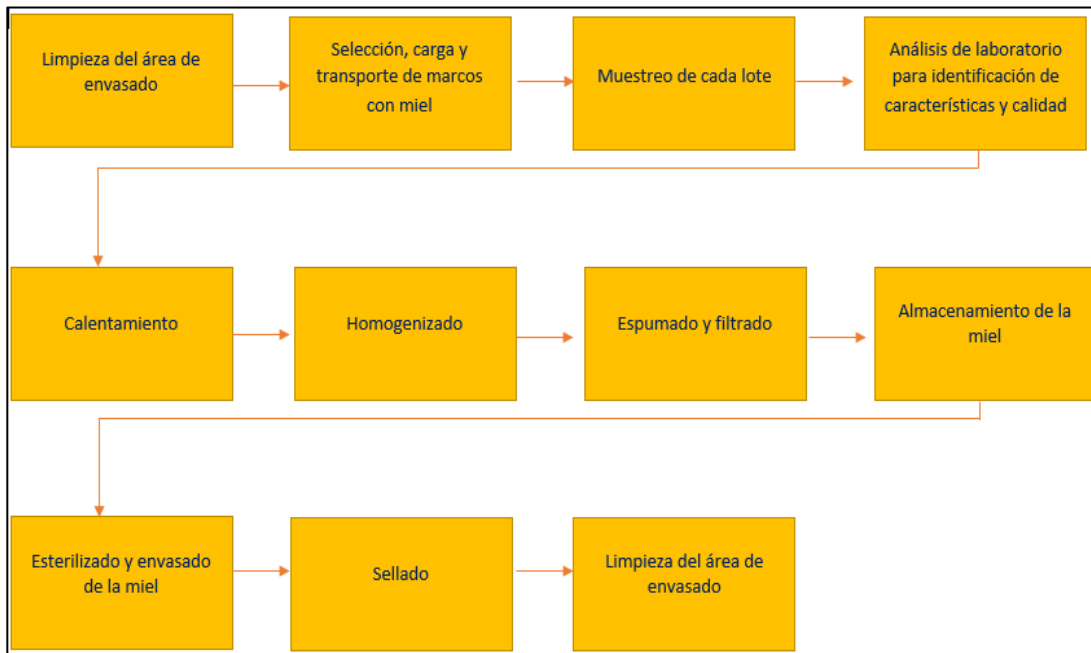
Figura 1. Diagrama de flujo envasado de la miel
