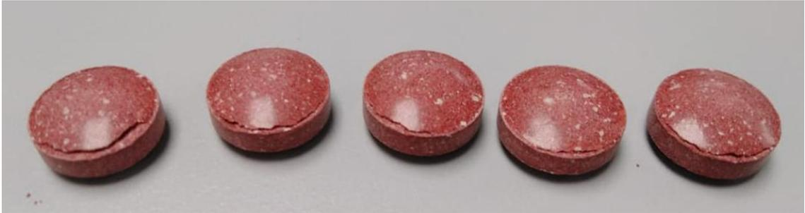
Problema de falta de lubricación, moteada, y problema en eyección en equipo de compresión. Tabletas dañadas en empaque primario (blíster).
