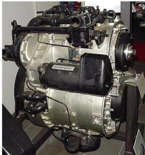
Fuente: *Motor Wankel Diesel del Rolls Royce R6.*
