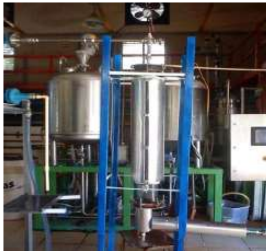
Figura 10. Destilación por arrastre de vapor a escala planta piloto
