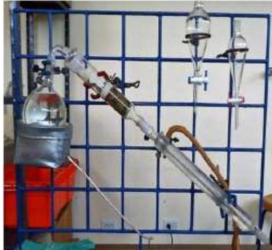
Figura 9. Destilación por arrastre de vapor a escala laboratorio
