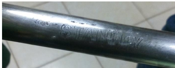
Figura 3. Revelación de caracteres borrados mediante trabajos en frío en maneral de hacer inoxidable gracias al ensayo de partículas magnéticas
