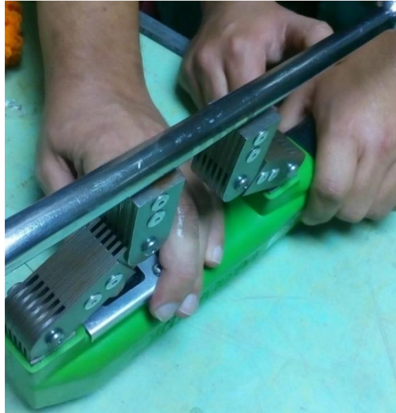
Figura 2. Ejecución de la magnetización de un maneral de acero inoxidable para ensayo de partículas magnéticas
