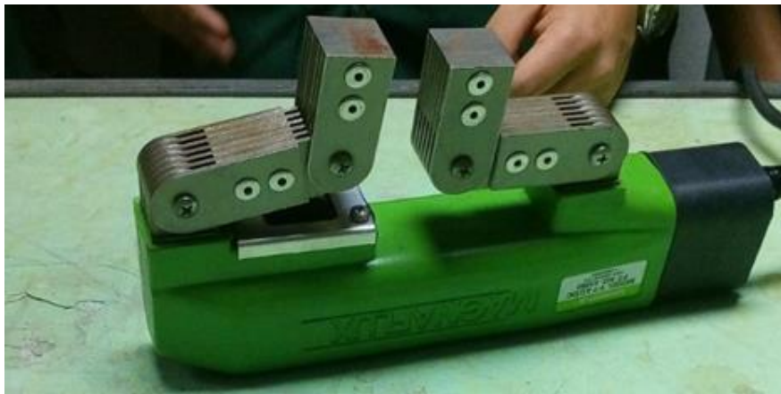
Figura 1. Yugo magnético MAGNAFLUX utilizado para el ensayo de partículas magnéticas
