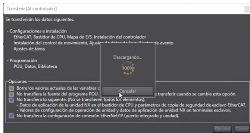
Figura 87. Transferencia al controlador
