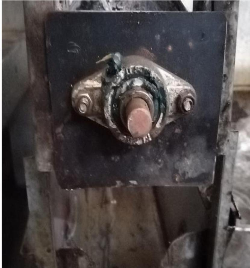
*Nota.* Rodamiento del sistema de enrollamiento de trampas. Elaboración propia.
