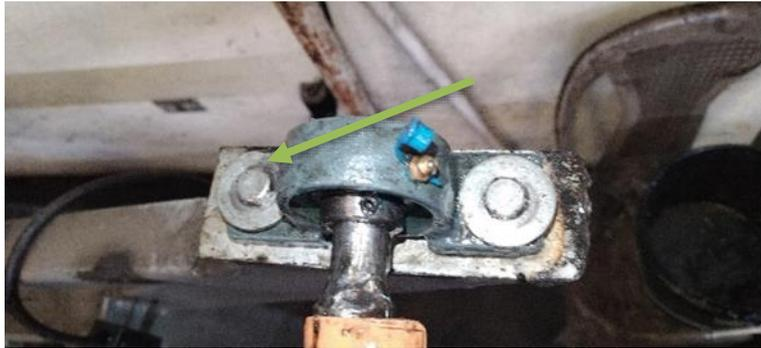
*Nota.* Rodamiento del sistema de enrollamiento de trampas, se ve dónde debe colocarse la pistola con la grasa lubricante. Elaboración propia.
