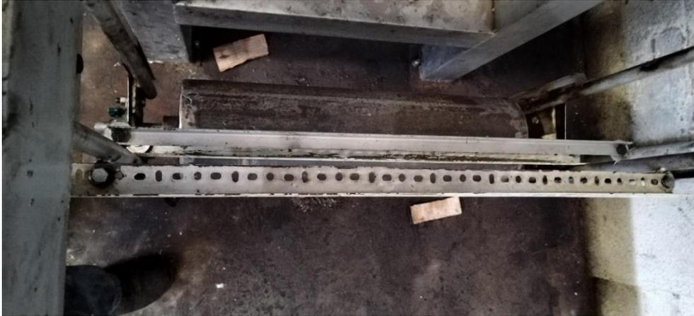
*Nota.* Mecanismos de remoción de excedentes de la máquina engomadora, donde se encuentra la cadena de casquillos y ruedas dentadas. Elaboración propia.
