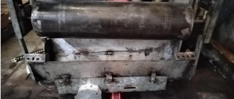
*Nota.* Limpieza del sistema de impregnación, cilindro de impregnación y tanque limpios.
