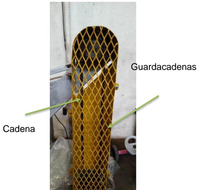
*Nota.* Mecanismo transmisión de potencia, se pueden observar las ruedas dentadas, cadena y porta cadenas. Elaboración propia.
