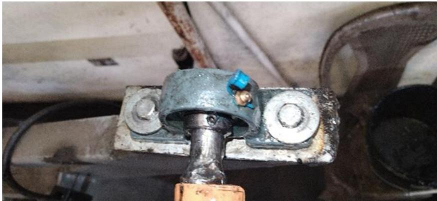
*Nota.* Rodamiento del sistema de enrollamiento de trampas. Elaboración propia.
