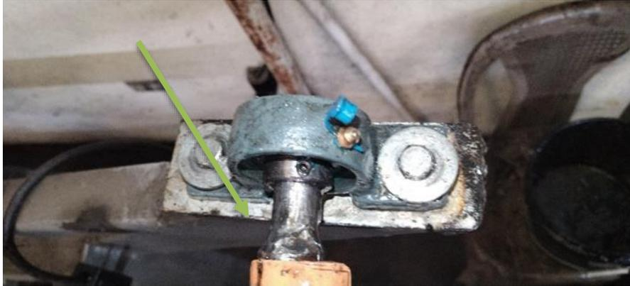
*Nota.* Rodamiento del sistema de enrollamiento de trampas, se ve como este está siendo afectado por los excedentes de pegamento. Elaboración propia.
