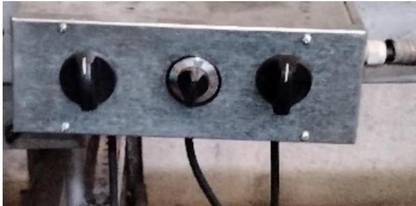
*Nota.* Sistema de calentadores para el tanque de pegamento de la máquina engomadora.
