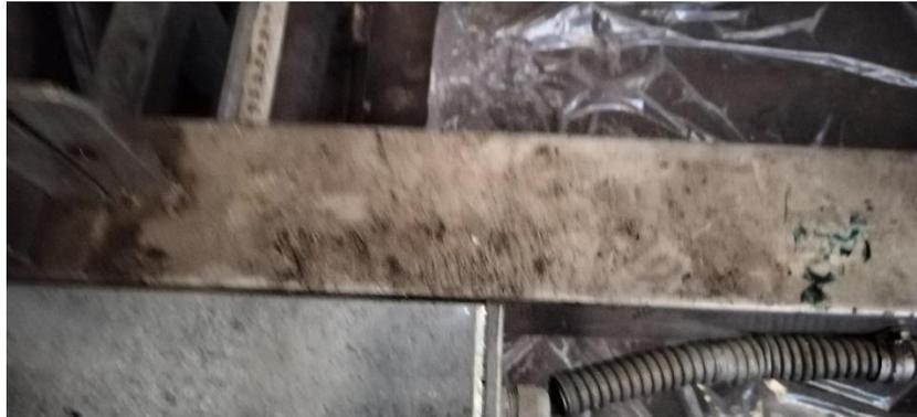
*Nota.* Partículas de suciedad y cuerpos extraños que suelen dar adheridas a la estructura de la máquina debido a la mala ejecución de las limpiezas. Elaboración propia.
