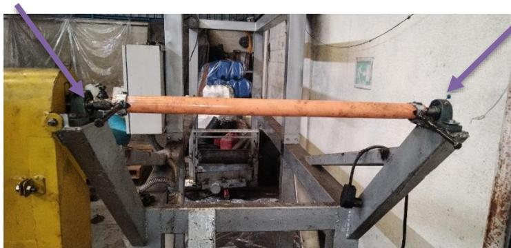
*Nota.* mostrando los puntos de acumulación de excedentes de pegamento. Sistema de enrollado de trampas, donde se dé nota que en los extremos se acumulan los excedentes de pegamento.
