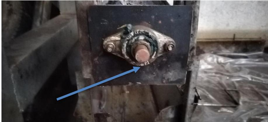
*Nota.* Rodamiento del cilindro de impregnación, se observa el excedente de grasa lubricante ya contaminada. Elaboración propia.
