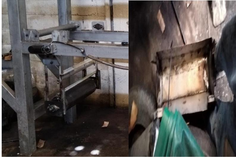
*Nota.* Mecanismos de impregnación de la máquina engomadora, donde se encuentra la cadena de casquillos y ruedas dentadas. Elaboración propia.
