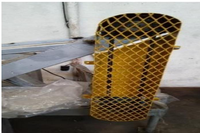
*Nota.* Mecanismos de transmisión de potencia de la máquina engomadora, donde se encuentra la cadena de casquillos y ruedas dentadas. Elaboración propia.
