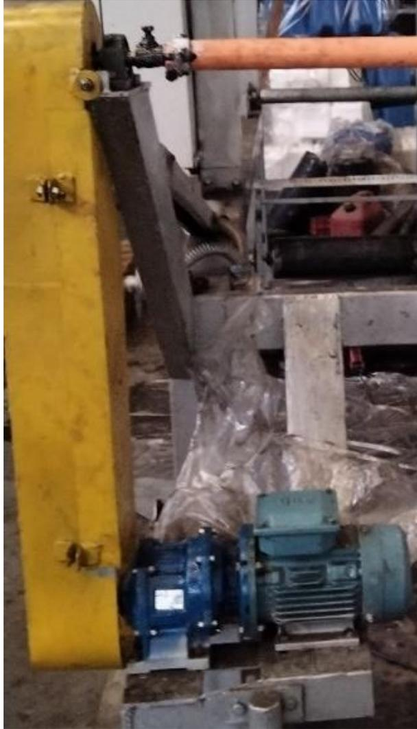
*Nota.* Mecanismo de transmisión de potencia y motor eléctrico de la máquina engomadora.
