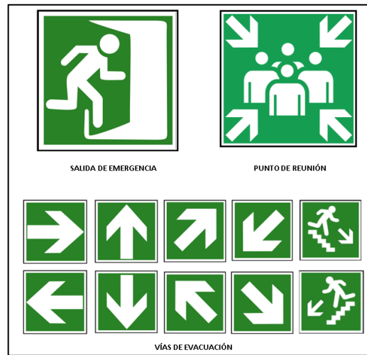
Figura 142. Señalización de evacuación
