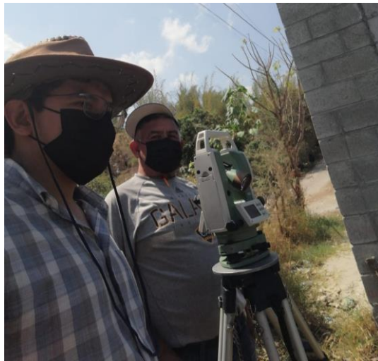
Figura 3. Levantamiento topográfico alcantarillado sanitario
