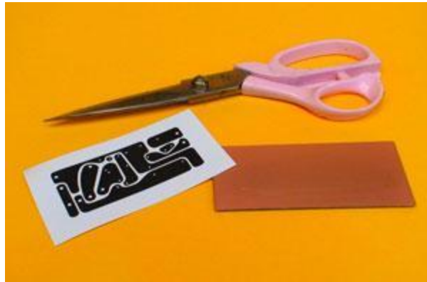
Figura 68. Dimensionar placa de cobre e impresión del circuito
