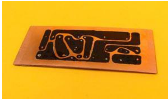
Figura 73. Resultado final del método de termo transferencia
