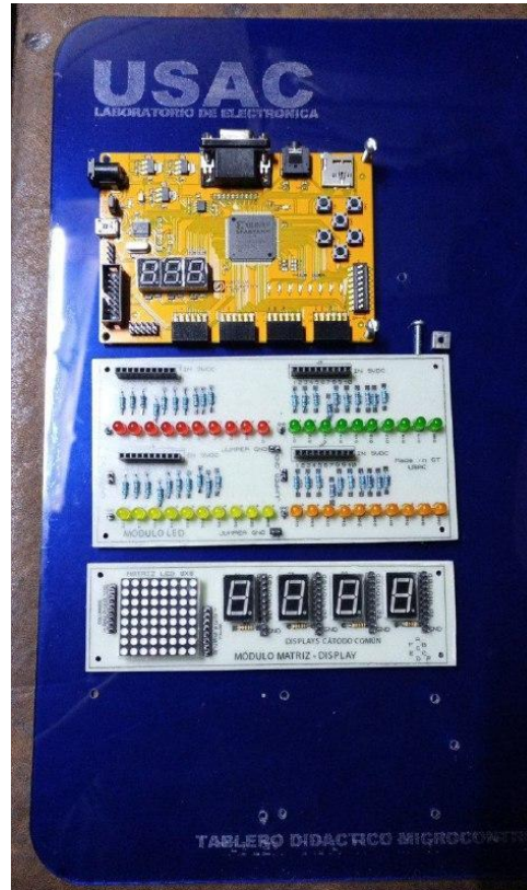
Figura 109. Ensamblaje de elementos en el tablero didáctico
