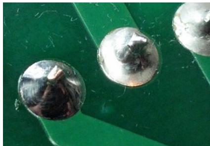
Figura 81. Soldadura circular correcta
