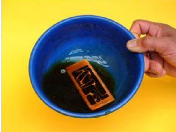
Figura 74. Revelado de PCB con cloruro férrico
