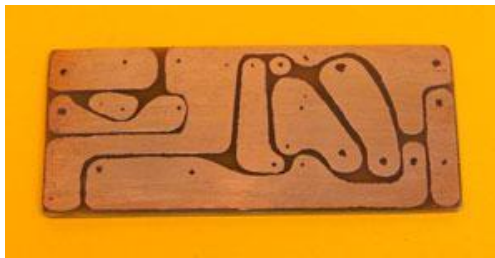
Figura 75. Resultado final del revelado de PCB
