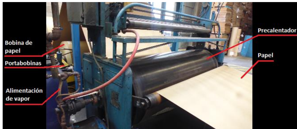
Figura 38. Precalentador liner interno
