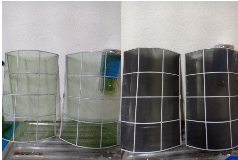
Figura 31. Filtros limpios vs., filtros sucios
