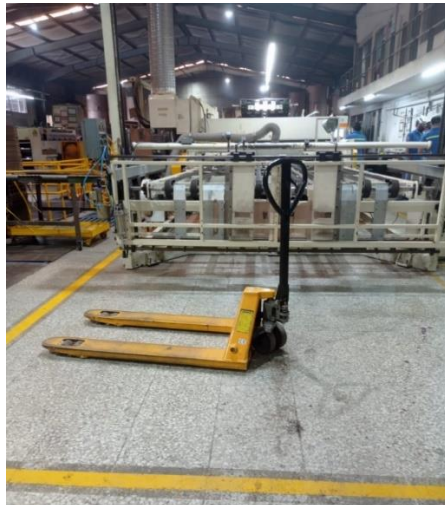
Figura 25. Colocación de mulitas en lugares inadecuados
