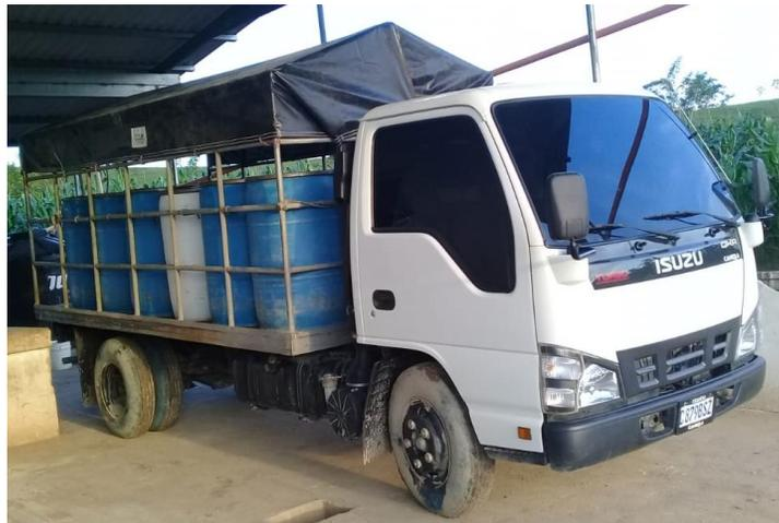
*Nota:* Camión tipo carrocería, utilizado para transportar carga no mayor a 3.5 toneladas sin necesidad de refrigeración. Elaboración propia.
