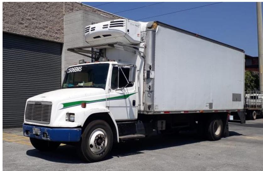
*Nota:* Camión tipo furgón, utilizado para transportar carga con refrigeración. Elaboración propia.
