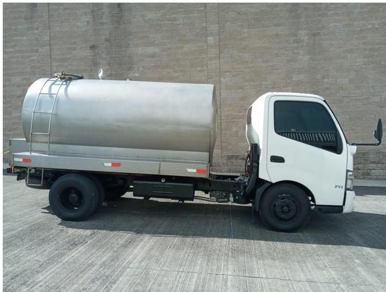
*Nota:* Camión tipo cisterna, utilizado para el transporte de leche cruda a temperaturas por debajo de los 5°C. Elaboración propia.
