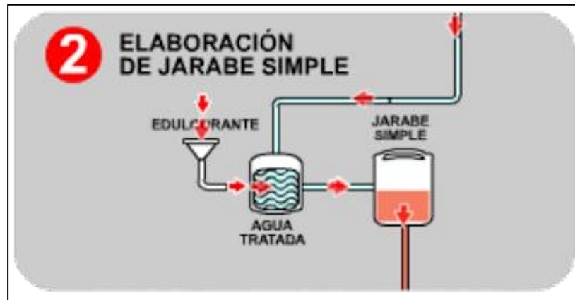
Figura 6. DFP de elaboración de jarabe simple
