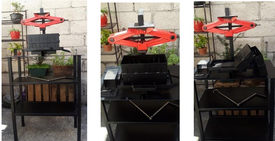
Figura 13. Máquina artesanal para fabricar briquetas rectangulares
