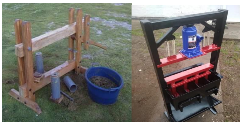
Figura 7. Máquinas de tipo artesanal para hacer briquetas
