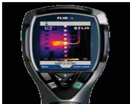
Figura 6. Cámara de termografía
