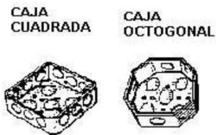
Figura 4. Cajas de conexión
