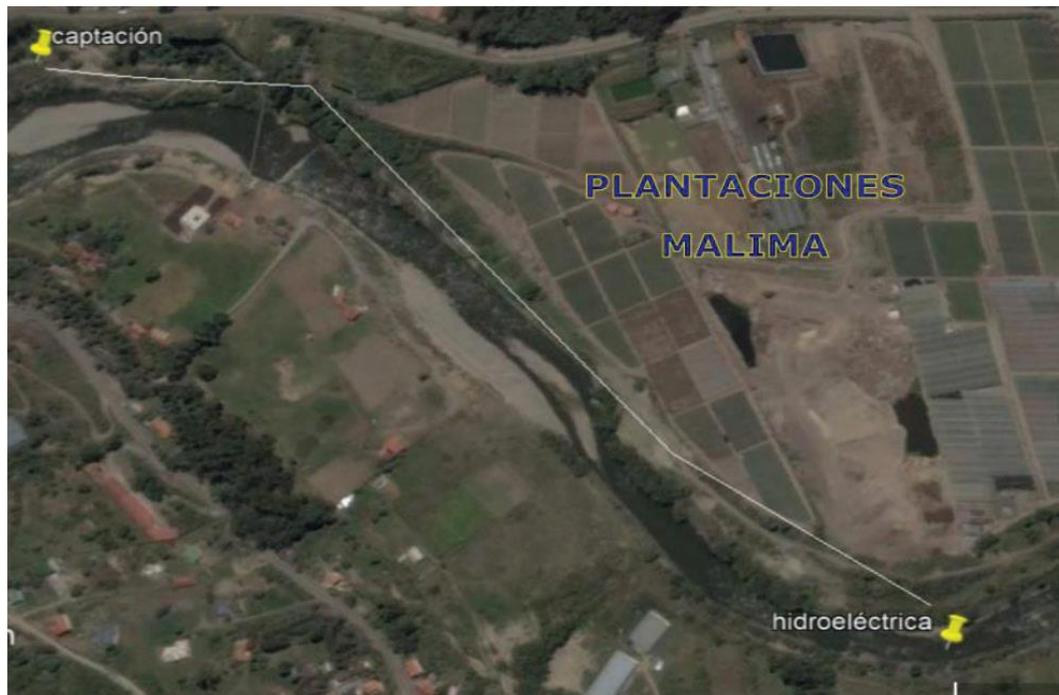
*Nota.* La figura muestra el salto neto hidroeléctrico. Obtenido de Palomeque, Valdez, Jara y Reinoso (2020) *Diseño de una Mini Central Hidroeléctrica* (pág.35).
