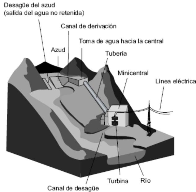
Nota. Como se puede observar en la figura 1 se detallan los elementos principales de dichas centrales y que en ocasiones se requieren una que otro componente según las necesidades del sitio. Obtenido de González, Calero, Colmenar y Castro (2009) *Centrales de energías renovables*. (p.431.) Pearson.
