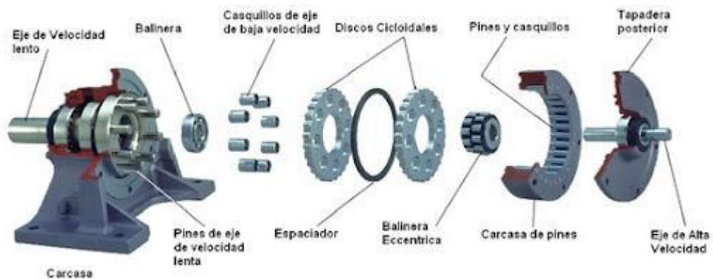
Figura 7. Componentes internos del reductor cicloidal
