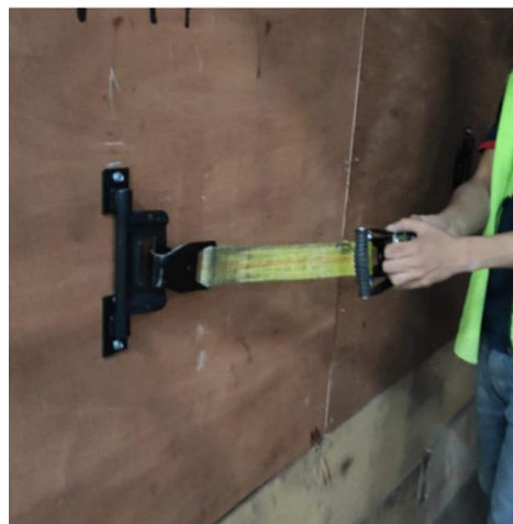
Figura 22. Ejemplo cincho de sujeción de carga en line haul
