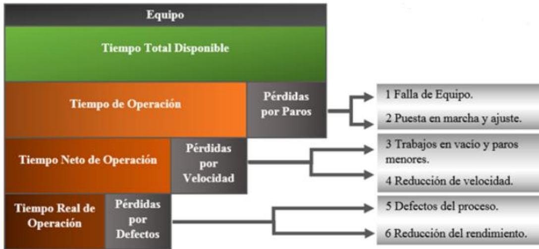
Figura 2. Proceso y estructura de un OEE, según Nakajima
