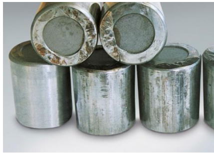
Figura 8. Rodamientos con desgaste por deslizamiento
