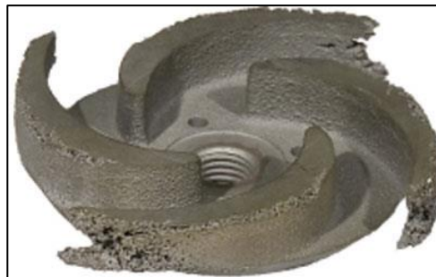
Figura 4. Impulsor de bomba con desgaste por cavitación
