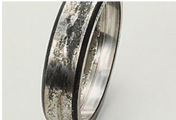
Figura 7. Pista interna de cojinete con desgaste por fretting
