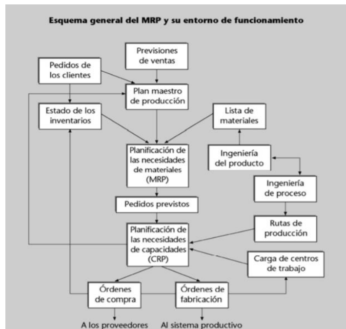
Figura 2. Esquema general del MRP y su entorno de funcionamiento
