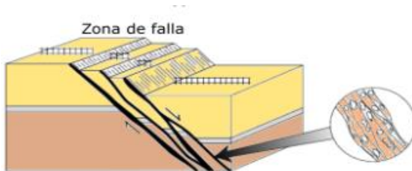
Figura 2. Zona de falla
