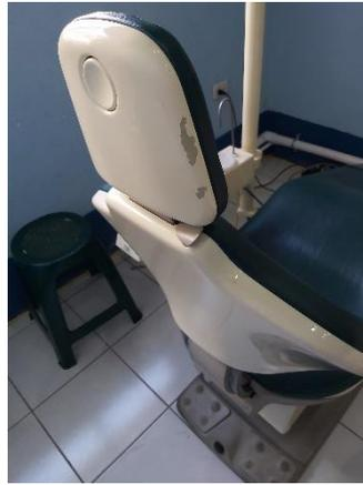
Unidad y silla dental en buen estado y funcionamiento, respaldo y cabezal con señales de desgaste, articulación del brazo de la unidad con óxido.
