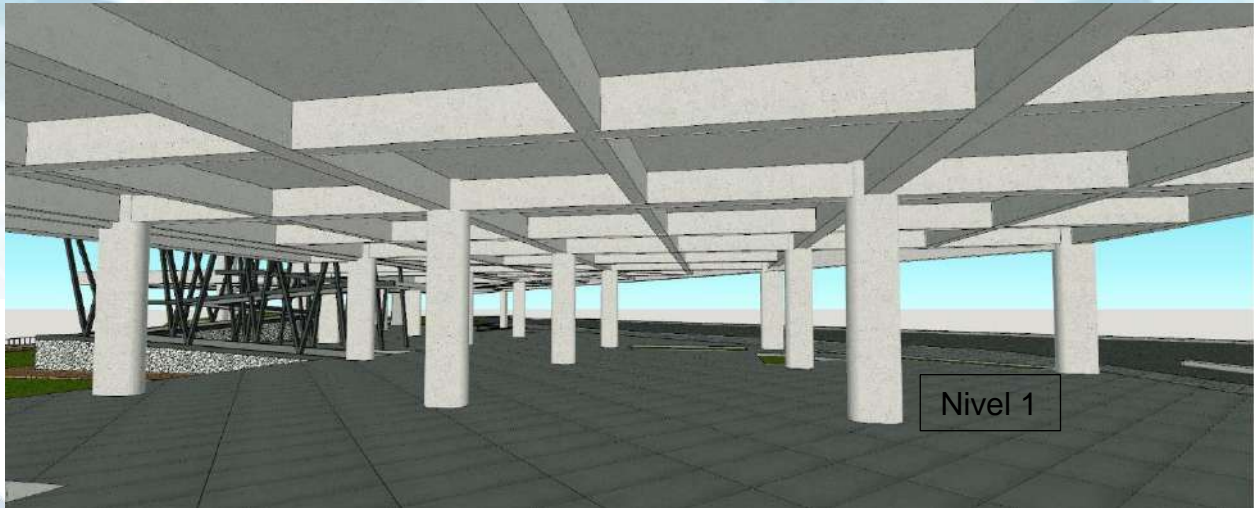
Vista / Render 22 - Marcos rígidos con vigas principales y secundarias en nivel 1 lado norte. - Fuente: Elaboración Propia
