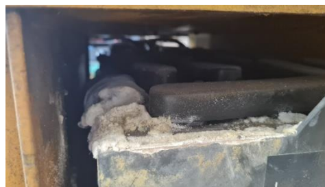
Figura 20. Corrosión en baterías de montacargas Yale ND18 fuera de servicio
