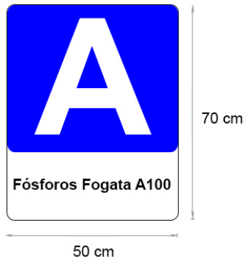
Figura 35. Rótulo de identificación de zonas de almacenaje
