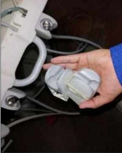
Documentación del cambio interno y externo de las mangueras, acoples, uniones para la caja de control del alta y baja velocidad, jeringa triple, colocación de los holders nuevos de alta, baja velocidad y holder de la succión. en las que se demuestran que los holder anteriores en mal estado y no funcionales y los repuestos nuevos ya colocados. Se debe armar y desarmar toda la caja de control de la unidad dental.
