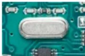
*Nota.* Fotografía de pines de Oscilador de frecuencia. Obtenido de Arduino.cc (2020). *Partes de un Arduino.* (<https://arduino.cl/principales-partes-de-un-arduino/>), consultado el 15 de abril de 2023. De dominio público.
