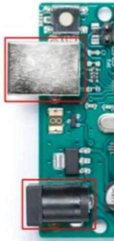
*Nota.* Fotografía de salidas de alimentación. Obtenido de Arduino.cc (2020). *Partes de un Arduino.* (<https://arduino.cl/principales-partes-de-un-arduino/>), consultado el 15 de abril de 2023. De dominio público.
