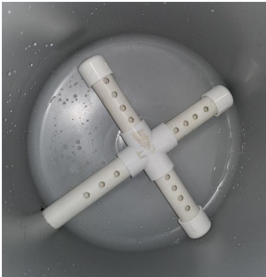
Figura 7. Instalación hidráulica dentro de un bote que utiliza filtro
