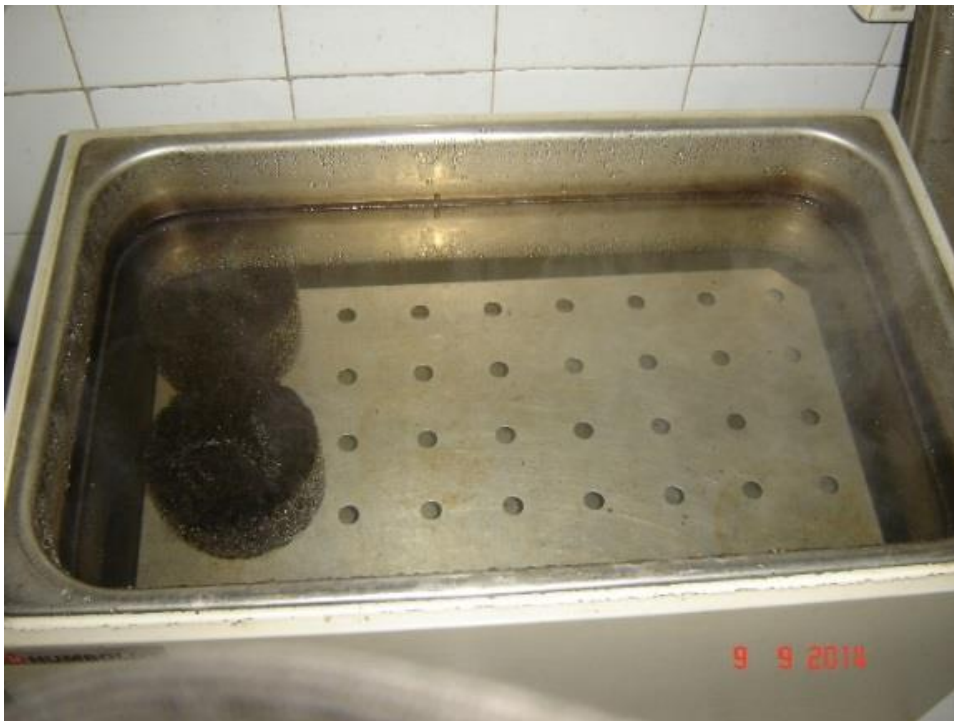
Figura 16. Briquetas en baño de María
