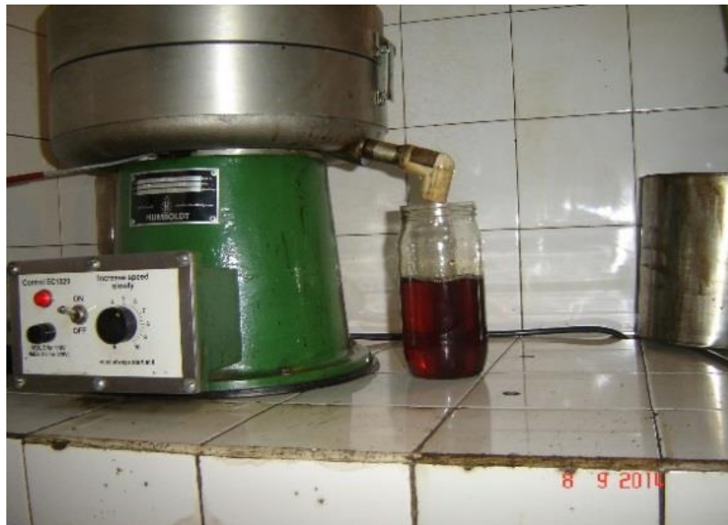
Figura 6. Extracción de asfalto (centrífuga)
