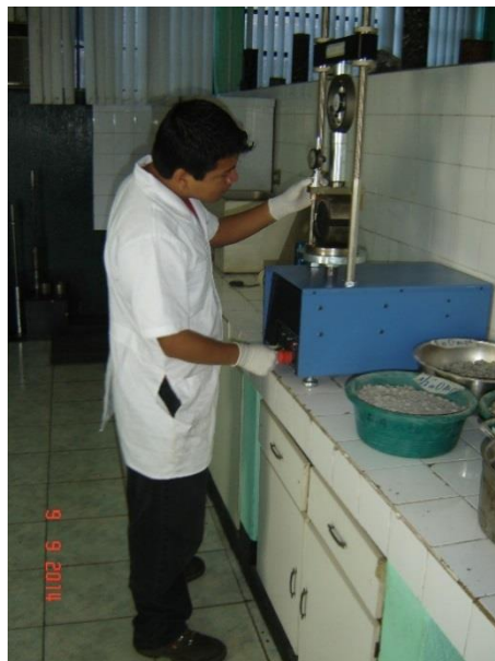
Figura 18. Lectura de dial de carga y de flujo
