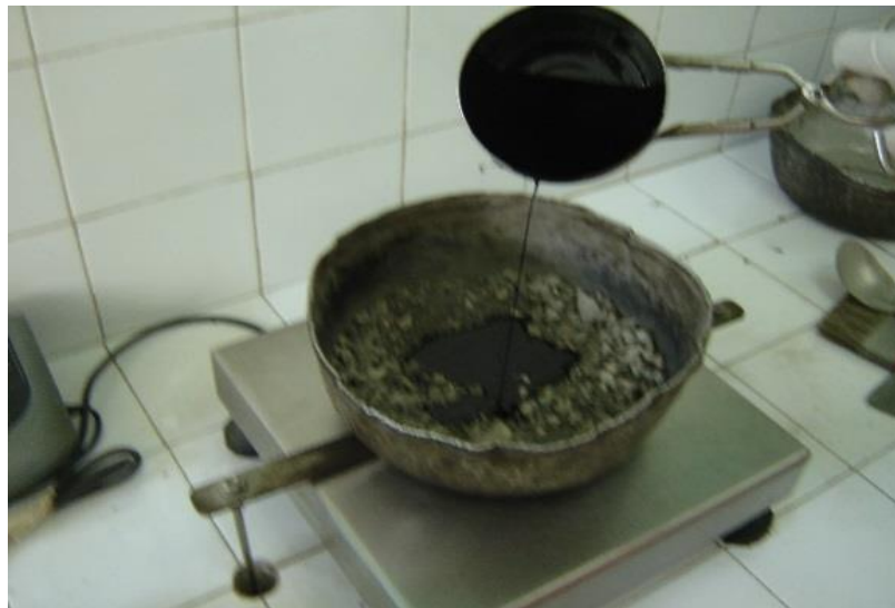
Figura 30. Agregados y asfalto previo a ser mezclados
