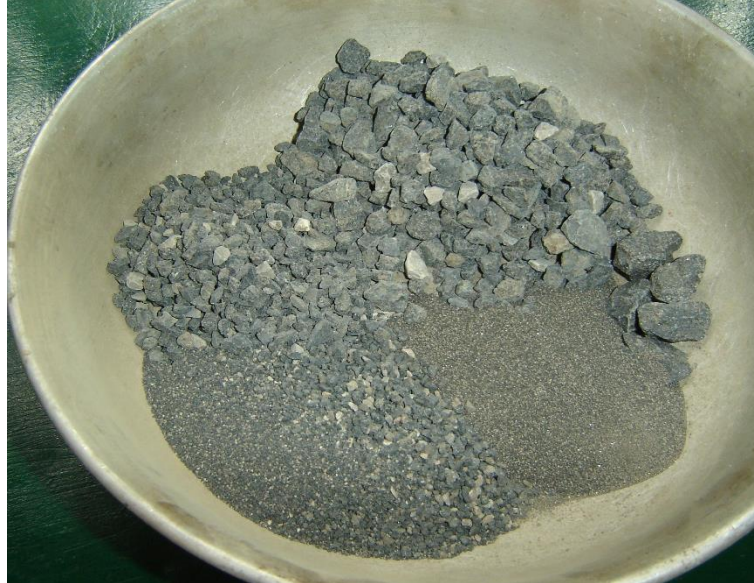
Figura 7. Mezcla sin asfalto
