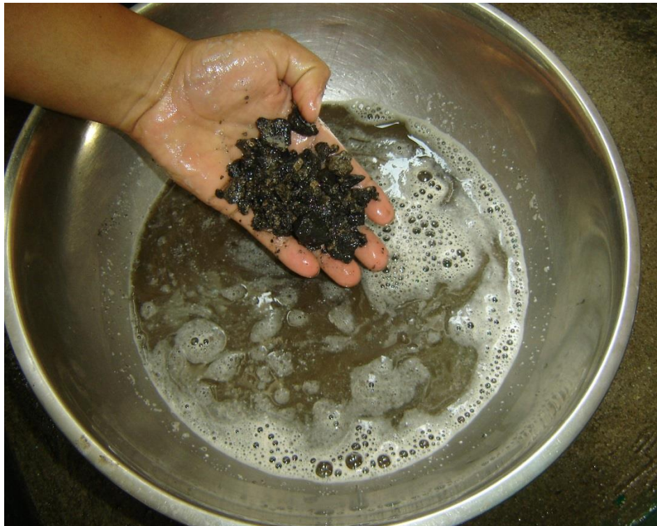
Figura 8. Lavado de material sin asfalto
