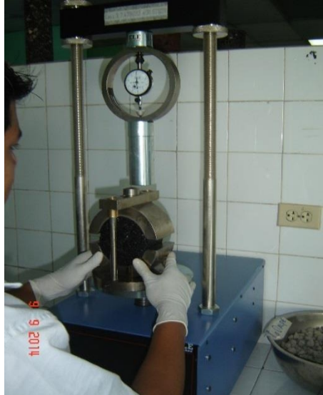
Figura 17. Colocación de briquetas a la máquina Marshall
