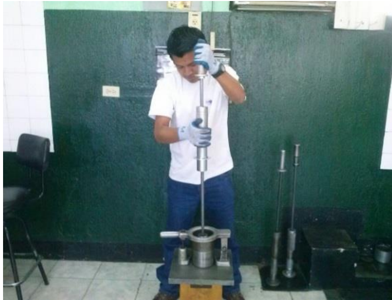
Figura 12. Compactación de briquetas Marshall
