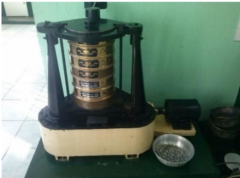
Figura 10. Tamizado de agregados
