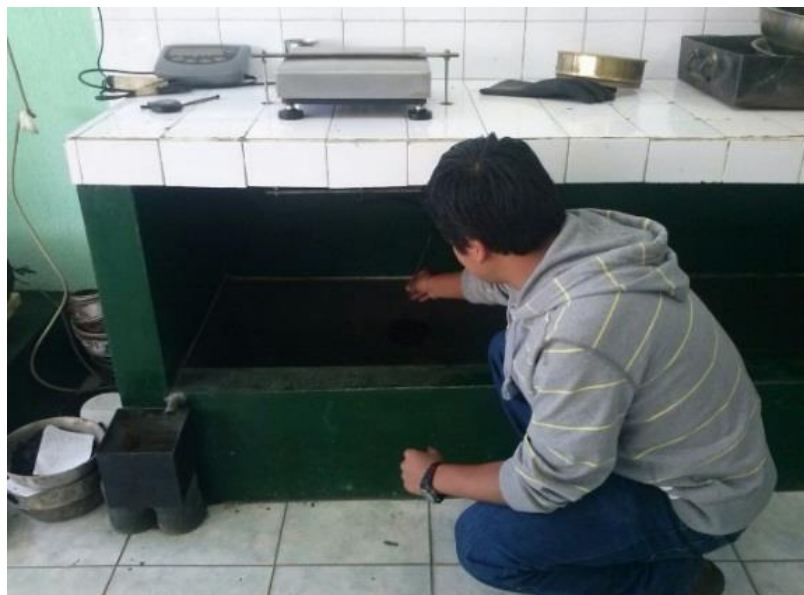
Figura 15. Peso briquetas en agua
