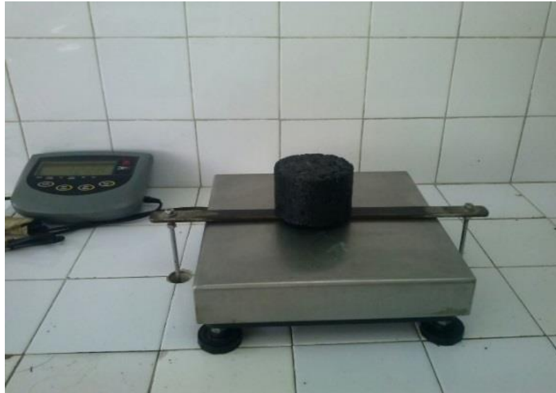
Figura 14. Peso de briquetas seco saturadas
