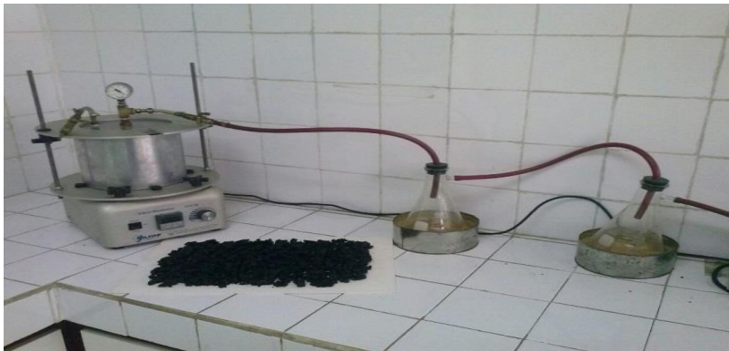
Figura 20. Vibrodesairador y mezcla para gravedad específica Rice
