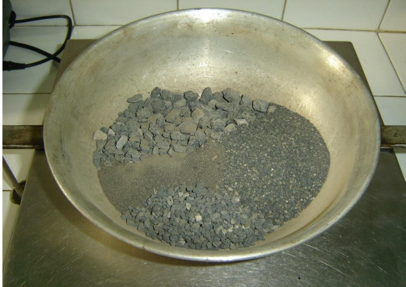
Figura 9. Agregado seco para tamizado
