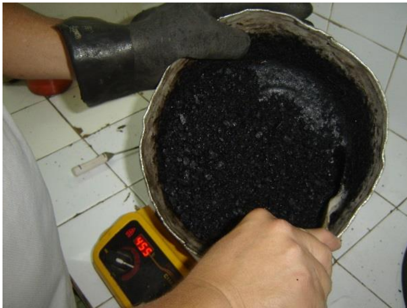
Figura 32. Mezcla asfáltica en caliente
