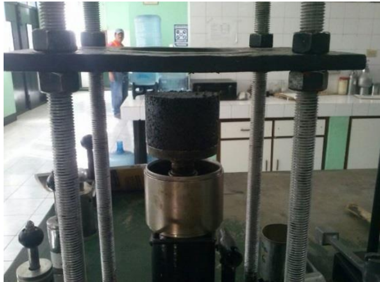
Figura 13. Extracción de briquetas
