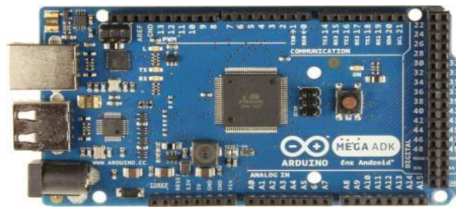
Figura 9. Arduino Mega ADK
