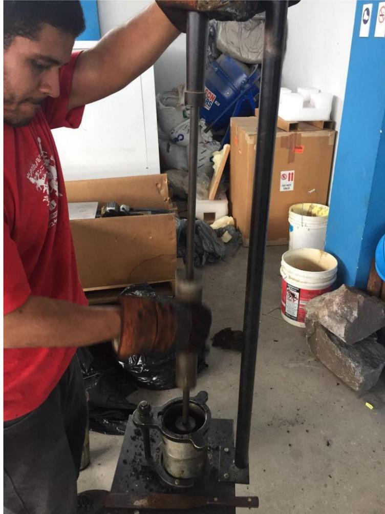
*Nota.* Compactación de mezcla asfáltica patrón y mezcla modificada con polibutadieno. Elaboración propia.
