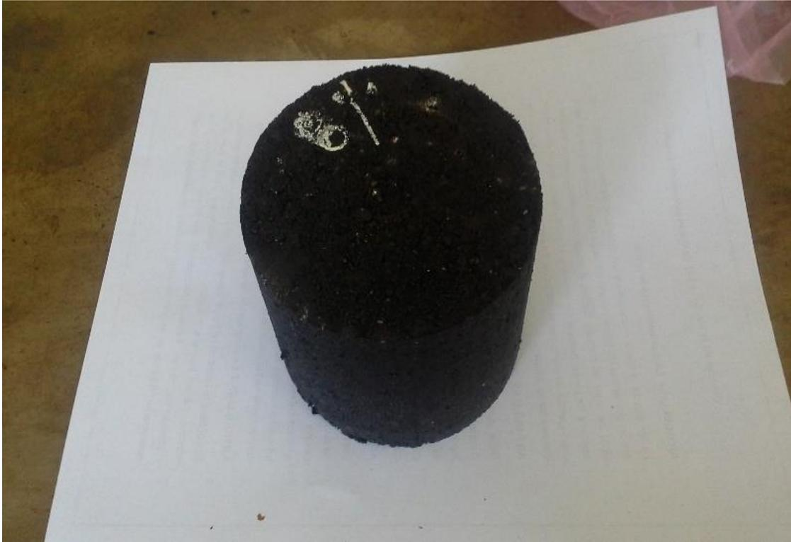
*Nota.* Desmoldado de probeta de asfalto. Elaboración propia.
