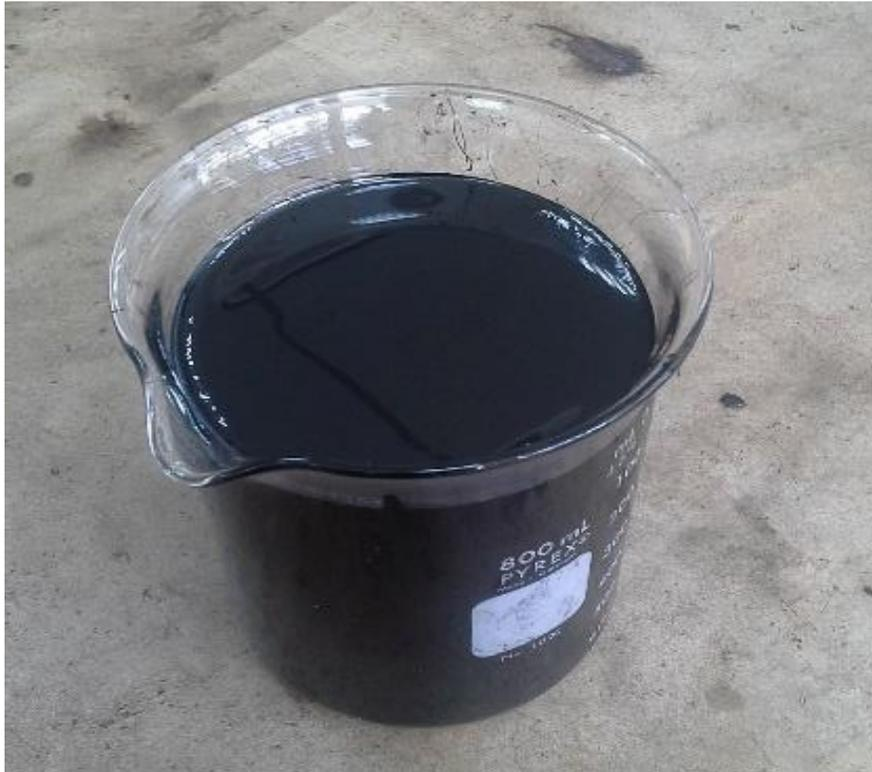
*Nota.* Cemento asfáltico AC-30 en estado líquido. Elaboración propia.
