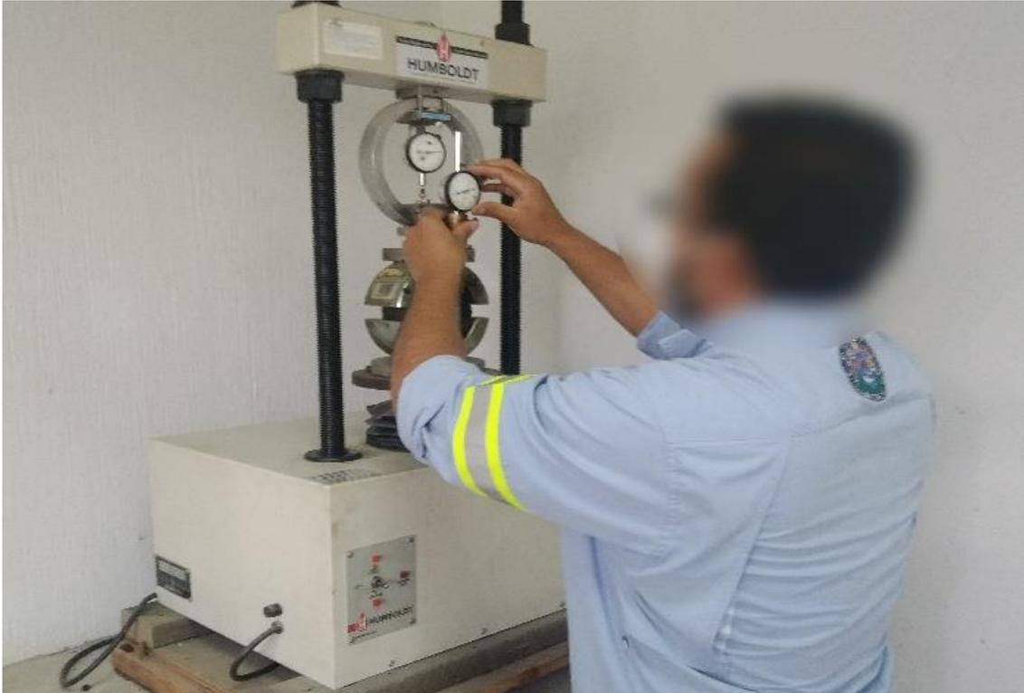
*Nota.* Proceso de colocación de probetas en máquina Marshall. Elaboración propia.
