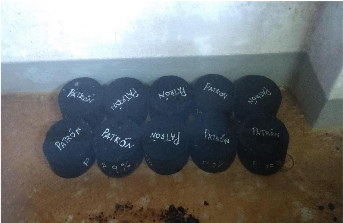
*Nota.* Probeta de mezcla patrón sumergida en tanque de agua. Elaboración propia.
