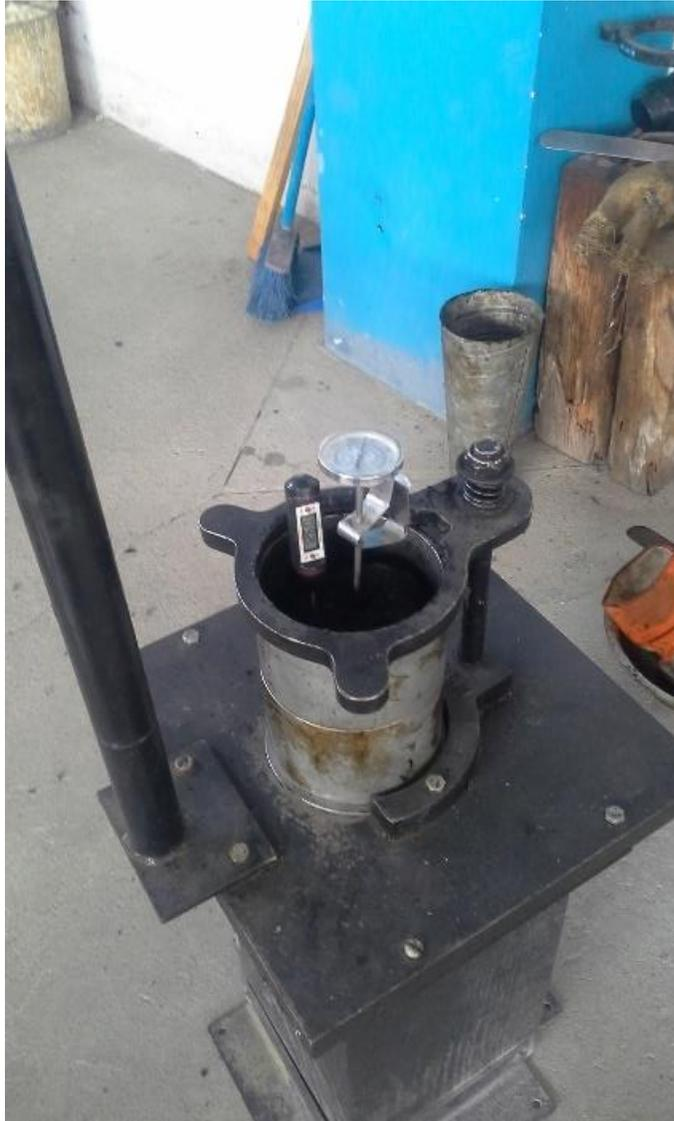
*Nota.* Colocación de mezcla asfáltica en moldes. Elaboración propia.
