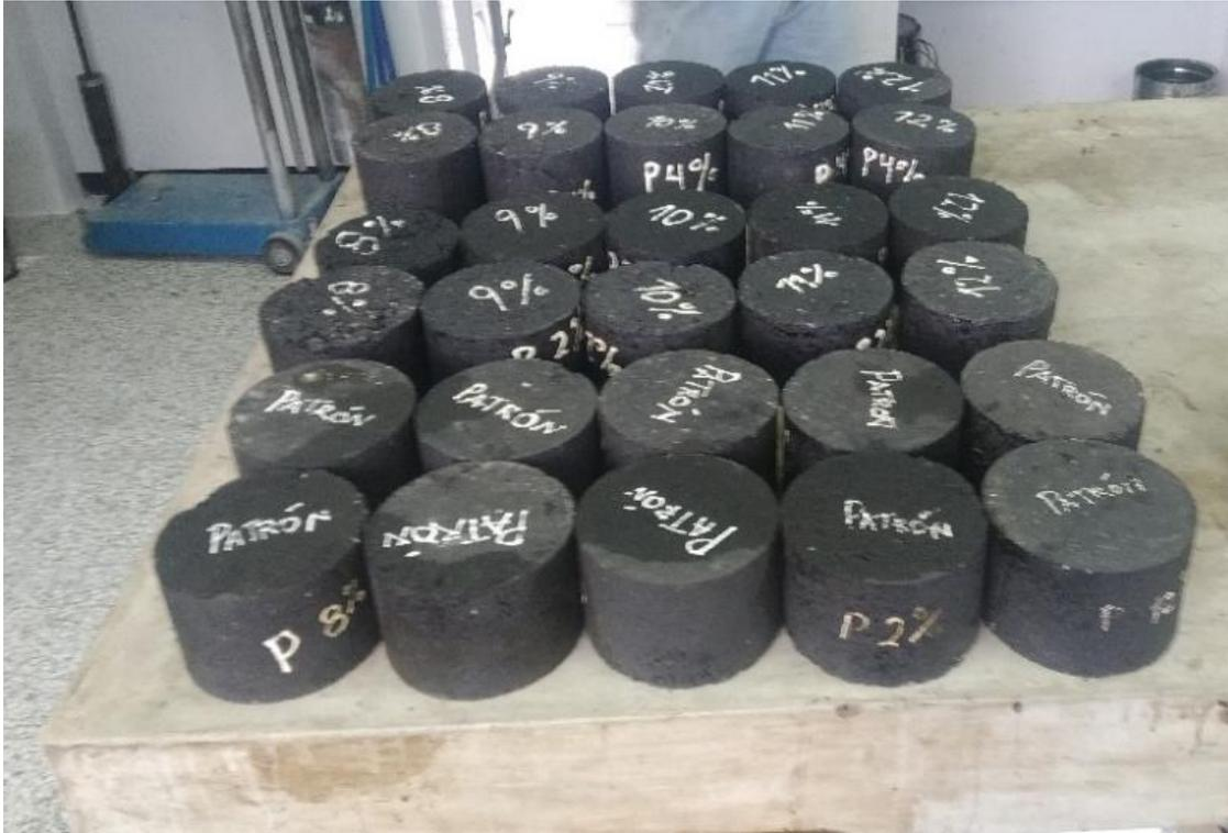
*Nota.* Secado de probetas de mezcla patrón y mezcla modificada con polibutadieno en porcentajes variados. Elaboración propia.
