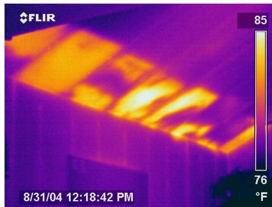
*Nota.* Cámara termográfica, para ver las áreas con carencias de aislamiento. Adaptado de Teldyne Flir (2019). *¿Cómo puede saberse si en su casa hay carencias de aislamiento?* (<https://www.flir.es/discover/professional-tools/how-can-you-tell-if-you-have-missing-insulation/>), consultado el 6 de enero de 2023. De dominio público.
