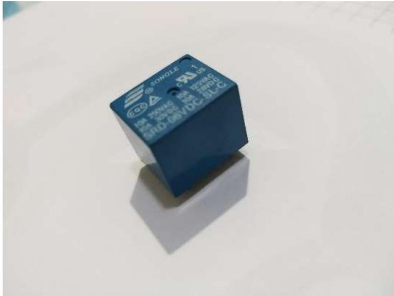
*Nota.* Fotografía de un relevador de baja potencia de un polo. Elaboración propia.
