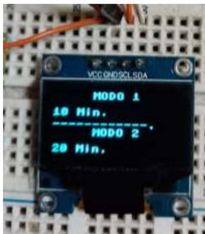
*Nota.* Figura que muestra la pantalla OLED en los modos de operación. Elaboración propia.
