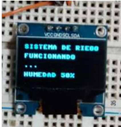
*Nota.* Figura que muestra la pantalla OLED durante el funcionamiento inicial, sin haber seleccionado un modo de riego. Elaboración propia.
