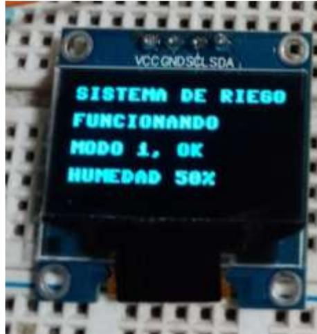
*Nota.* Figura que muestra la pantalla OLED funcionando en un modo de operación seleccionado y el porcentaje de humedad del sensor. Elaboración propia.
