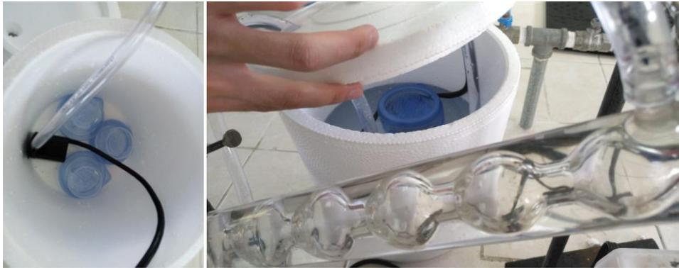
*Nota.* Detalle del interior del sistema de recirculación de agua enfriada utilizando mezclas en el punto eutéctico.
