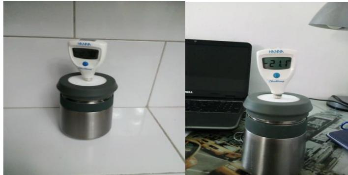
*Nota.* Detalle de medición de temperatura mezclas dentro del calorímetro para determinación del punto eutéctico.
