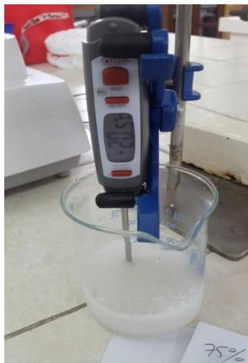
*Nota.* Detalle de medición de temperatura mezclas de mezclas expuestas al ambiente para determinación del punto eutéctico.
