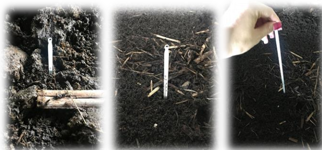
Figura 9. Tomas de temperaturas en piletas de producción de lombricompost: (izquierda a derecha) estrato bajo, estrato medio y estrato alto.
