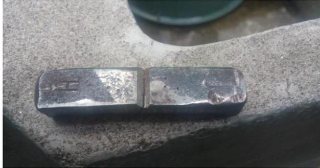
*Nota.* Probeta de acero SAE 1045 fabricado por proceso de corte oxiacetilénico. Adaptado de E. Oxlaj (2016). *Estudio comparativo de las propiedades mecánicas del acero 1045 bajo las normas ASTM E8, E10 y E23 mediante corte abrasivo y oxiacetilénico.* (<https://www.repositorio.usac.edu.gt/>), consultado el 8 de febrero de 2023. De dominio público.
