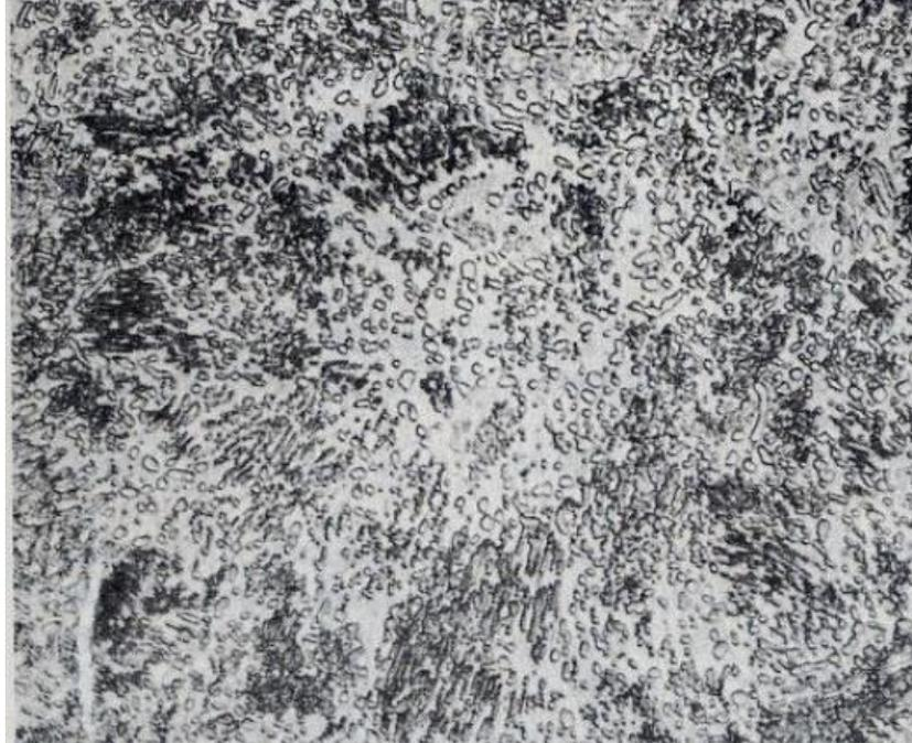
*Nota.* Acero de alto contenido de carbono recocido por esferoidización. Obtenido de S. Avner (1988). *Introducción a la metalurgia física 2.* (p. 256.) McGraw Hill/Interamericana de México.
