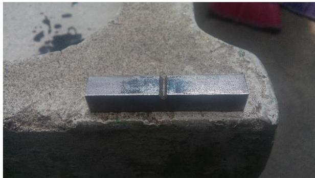
*Nota.* Probeta de acero SAE 1045 fabricado por proceso de corte abrasivo. Adaptado de E. Oxlej (2016). *Estudio comparativo de las propiedades mecánicas del acero 1045 bajo las normas ASTM E8, E10 y E23 mediante corte abrasivo y oxiacetilénico.* (<https://www.repositorio.usac.edu.gt/>), consultado el 8 de febrero de 2023. De dominio público.
