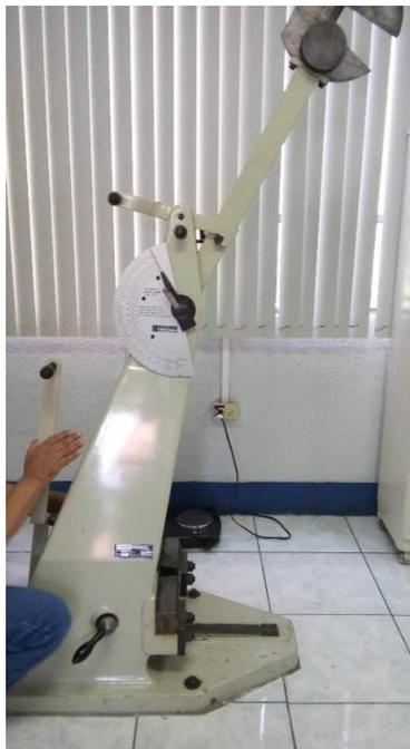
*Nota.* Péndulo utilizado para el ensayo de impacto Charpy. Adaptado de E. Oxlaj (2016). *Estudio comparativo de las propiedades mecánicas del acero 1045 bajo las normas ASTM E8, E10 y E23 mediante corte abrasivo y oxiacetilénico.* (<https://www.repositorio.usac.edu.gt/>), consultado el 8 de febrero de 2023. De dominio público.
