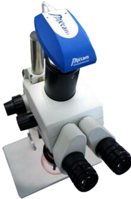
*Nota.* la cámara digital de nuevo alcance, posee el software integrado a su sistema de barrido y análisis muestral. Obtenido de Pax-it (2022). *Cámara digital USB 2.0 para microscopio.* (<https://www.paxit.com/camara-digital-usb-2-0-para-microscopio/>), consultado el 30 de julio de 2022. De dominio público.
