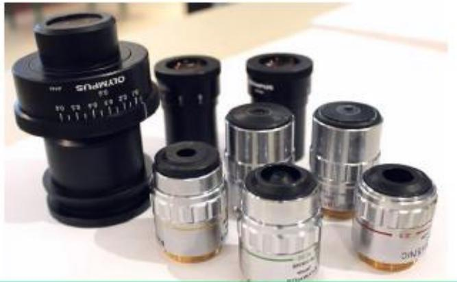
*Nota:* Ejemplo de los diferentes lentes a utilizar. Obtenido de A. Sole (2009). *Instrumentos industriales, su ajuste y calibración.* (p. 122). Alfaomega.
