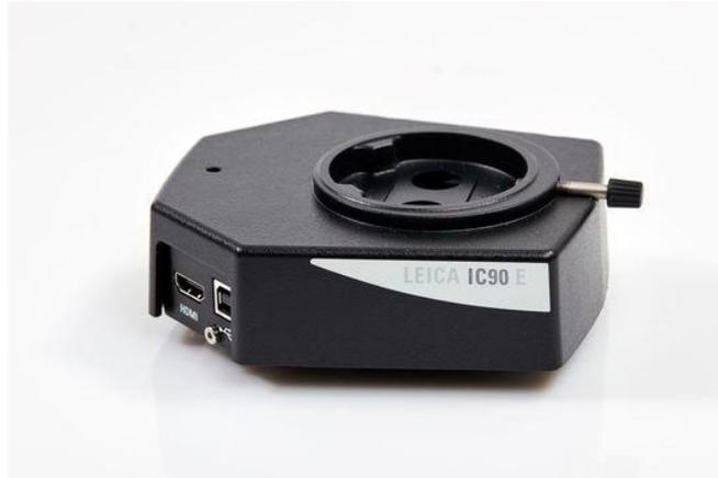
*Nota.* Este tipo de cámara presenta versatilidad el incorporar dispositivos auxiliares para compartir la imagen vía cable coaxial. Obtenido de LEICA (2019). *Cámaras de microscopia.* (<https://www.leica-microsystems.com/es/productos/camaras-de-microscopia/>), consultado el 30 de julio de 2022. De dominio público.
