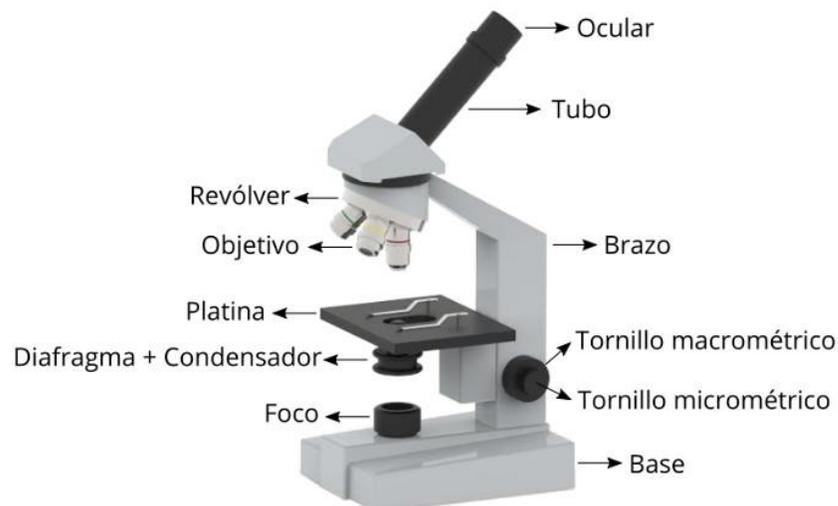
*Nota.* La imagen detalla cuales son las partes principales y externas de un microscopio, haciendo un barrido breve por las piezas fijas y piezas móviles, el principal cuidado es en los lentes, que por un mal uso pueden perder calibración. Obtenido de Mundo Microscopio (2023). *Historia del microscopio.* (<https://www.mundomicroscopio.com/historia-del-microscopio/>), consultado el 3 de mayo de 2023. De dominio público.
