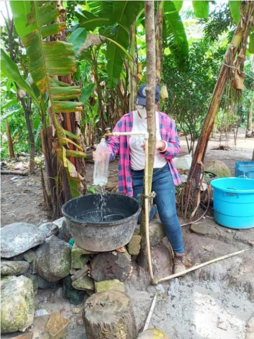
**Figura 15. Toma de muestra de agua entubada**
