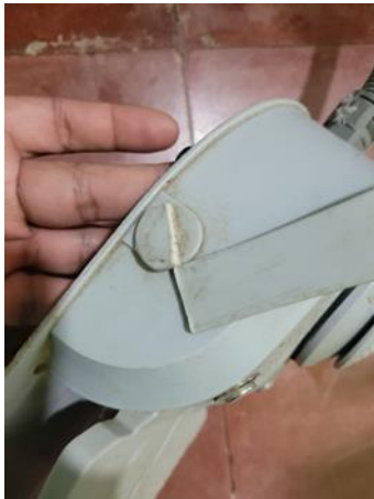
Reparación de varias fracturas en unidad dental.
