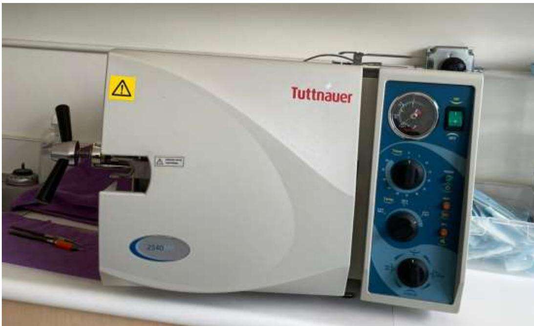
Autoclave para esterilizar instrumentos.
