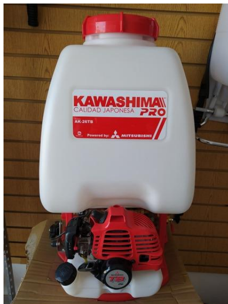
Figura 8. Bomba de mochila Kawashima con motor Mitsubishi utilizada para la aplicación de los tratamientos.
