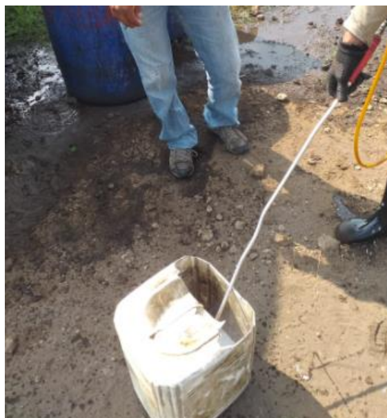
Figura 7. Medición del caudal de descarga de boquillas en un minuto para calibración del equipo.
