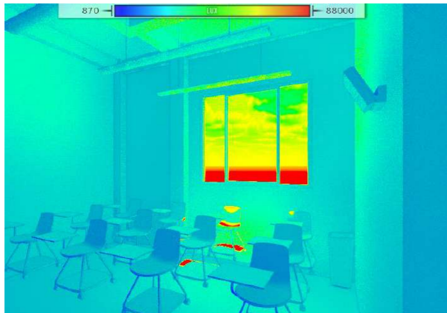
Interior Fachada Oeste (13:00 horas) Salón de Capacitaciones (Sin Parteluces)
