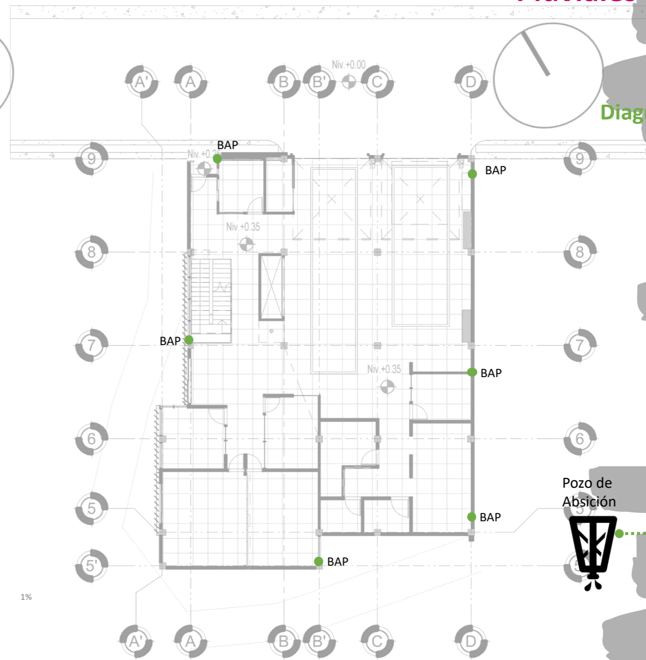
Esquema Planta Instalaciones Pluvial Nivel 1 Esc. 1:200
