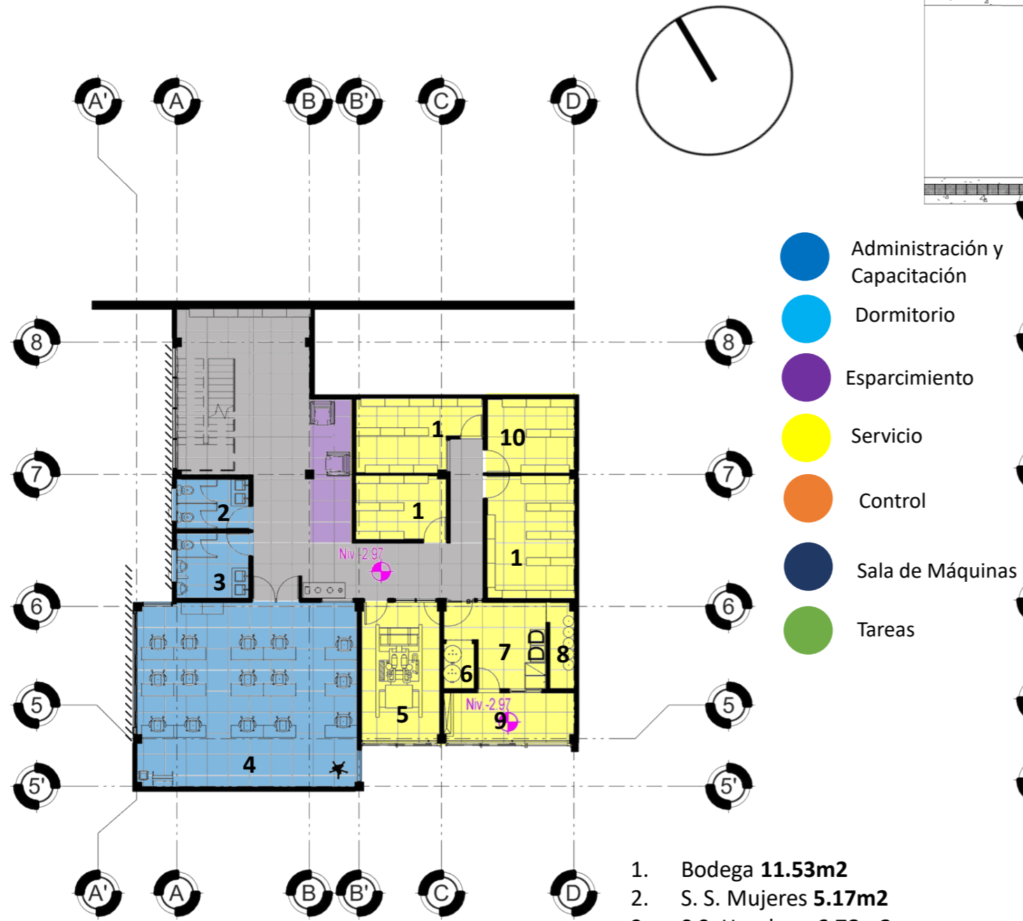
Planta de Zonificación Sótano Esc. 1:200
